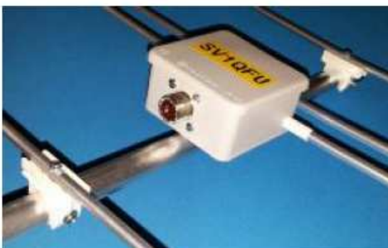
Εικόνα 1 - Το κουτί τροφοδοσίας (Feed point).
