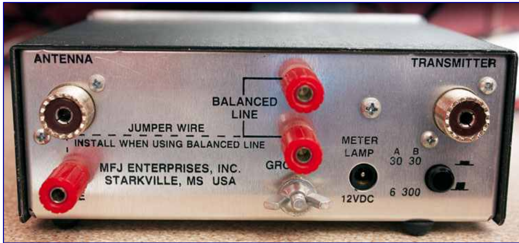
Antenna tuner με ασύμμετρη είσοδο και συμμετρική – Balance έξοδο.
